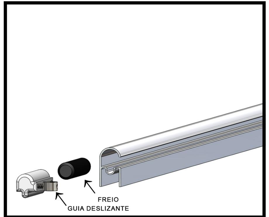
2. Montagem para abertura da porta à direita. Caso seja necessário mude o furo do parafuso do deslizante.
