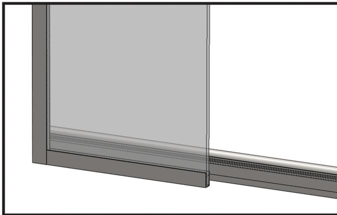
6. Posicione o perfil 11 mm na parede, no local que será encaixado o vidro fixo, corte um pedaço do mesmo perfil da largura do vidro fixo e instale-o no chão. Use as cunhas para nivelamento..
