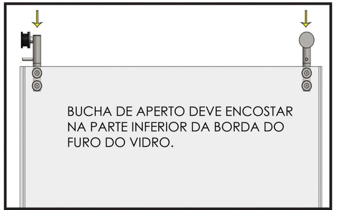
5. Para facilitar a regulagem, instale as hastes com as regulagens para baixo. Assim, basta afrouxar o parafuso para permitir que o vidro alinhe.
