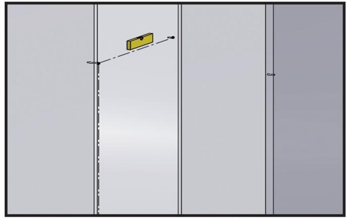
3. O furo do trilho tem que estar em prumo com a parte interna do perfil capa. **Atenção** o prumo **NÃO** pode ser no centro do perfil.
