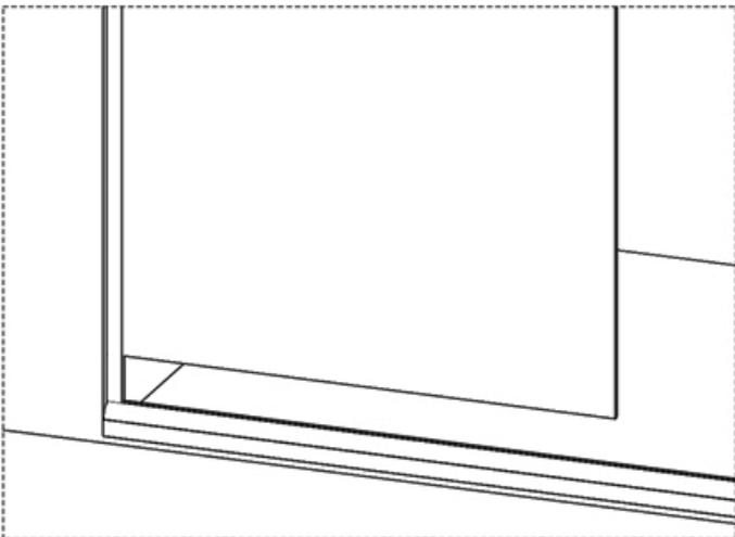
**5.** Corte o perfil lateral cavalinho, aparafuse e vede na parede. Não esquecer de encaixar a fita de vedação.
