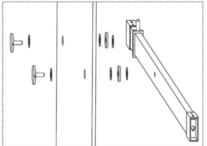
**7.** Cortar o trilho superior 40 mm menor que o vão. Furar e fixar o trilho no vidro fixo. Não esquecer de colocar as arruelas de proteção e o espaçadores.
