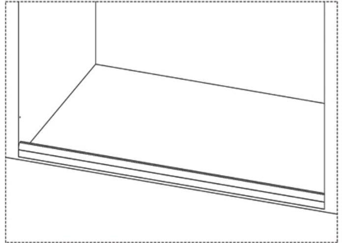
**3.** Corte o perfil guia na mesma medida do vão. É necessário fazer furos pequenos na parte de trás do perfil para ajudar no escoamento da água. Aparafuse e vede o perfil no chão.
