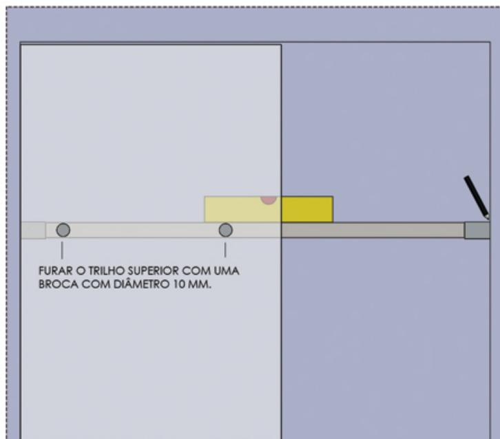
Nivelar o trilho superior e com auxílio de um lápis marcar as posições das luvas do trilho, achar o centro e furar com uma broca de 8 mm de diâmetro.
