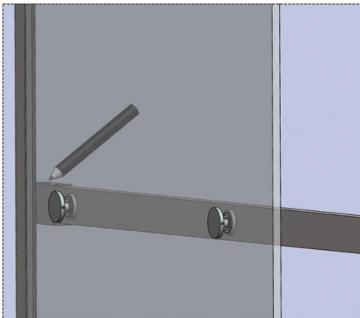
Para achar o local dos furos do trilho superior, aconselhamos fixar o trilho superior no vidro fixo. Não esquecer de colocar as arruelas de proteção e o espaçador.
