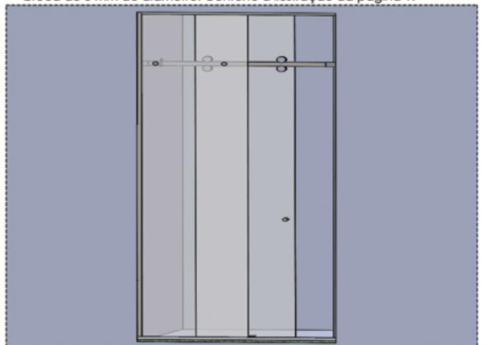
**11.** Monte as roldanas superiores no vidro movél, encaixe o vidro na guia inferior e no trilho superior.
