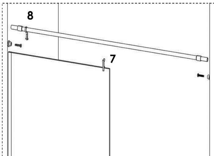
**7.** Encaixe no vidro fixo o suporte do trilho superior a 70 mm da extremidade.
