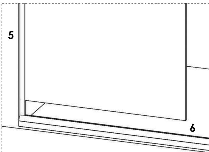
**5.** Corte o perfil lateral cavaleiro, aparafuse e vede na parede. Não esquecer de encaixar a fita de vedação.
