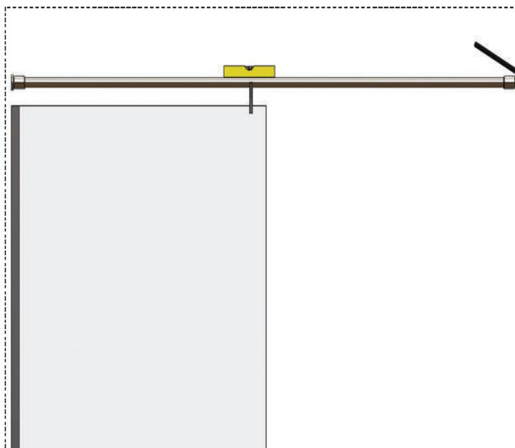
Colocar o suporte do tubo a 50 mm da extremidade do vidro fixo, com ajuda de um nível é possível marcar o local do furo da bucha na outra parede.
