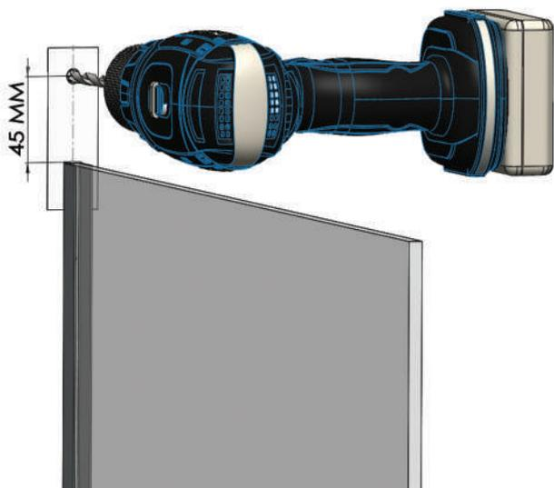
Usar o gabarito para marcar o local do furo na parede onde está instalado o vidro fixo. Depois da marcação feita, fazer o furo e instalar a bucha de fixação, encaixar o trilho superior e apertar a luva do trilho.
