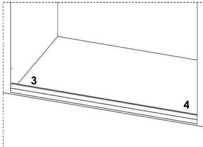
**3.** Corte o perfil guia na mesma medida do vão. É necessário fazer furos pequenos na parte de trás do perfil para ajudar no escoamento da água. Aparafuse e vede o perfil no chão.
